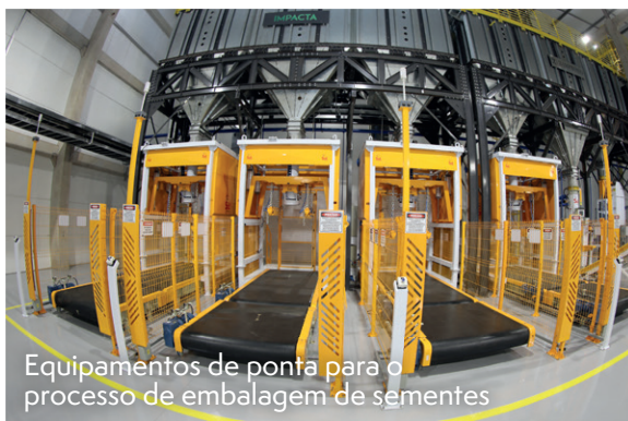
Três linhas automatizadas de escaneamento, com aplicação robotizada de sacaria e paletização
